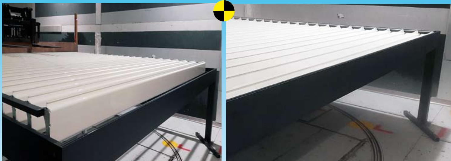
Se ha sometido la pérgola a diferentes incidencias de viento para diferentes **configuraciones de apertura / cierre** de lamas hasta **velocidades elevadas**. Cuando el viento actúa de forma perpendicular a las lamas, éstas pueden sufrir más y los desplazamiento pueden alcanzar niveles elevados. No se ha observado ninguna **fragilidad en las lamas ni en las fijaciones**.
