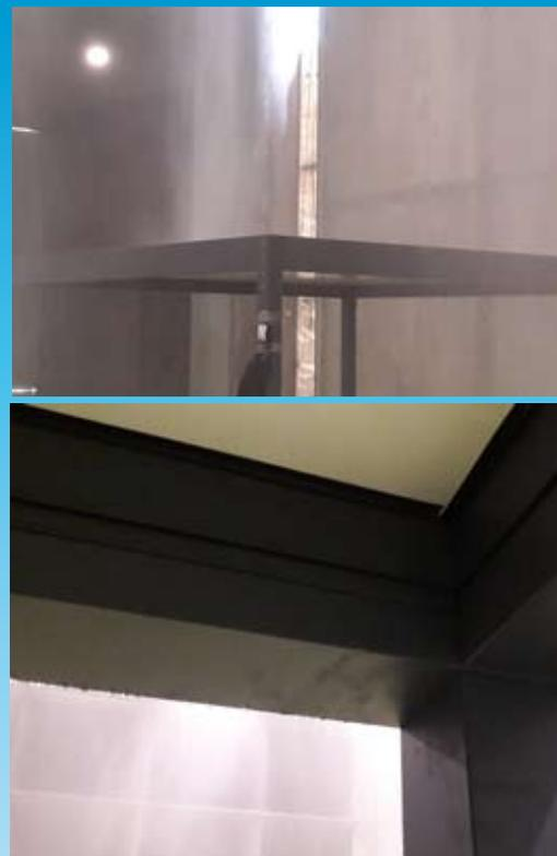
Con esta prueba realizada en la Pérgola Horizon «ISLA» de 4m x 4m en una altura estándar de 2 metros, se ha podido comprobar que no hay goteras, que es **completamente estanca entre las lamas** en posición cerrada con la evacuación de los desagües de los pies en la caída del agua de lluvia.
