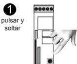
Con el receptor conectado a la corriente eléctrica y el motor conectado en él pulsar UNA vez en el botón de programación P3 (situado en el interior del receptor)
