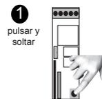
Con el receptor conectado a la corriente eléctrica y el motor conectado en él pulsar UNA vez en el botón de programación P3 (situado en el interior del receptor)
