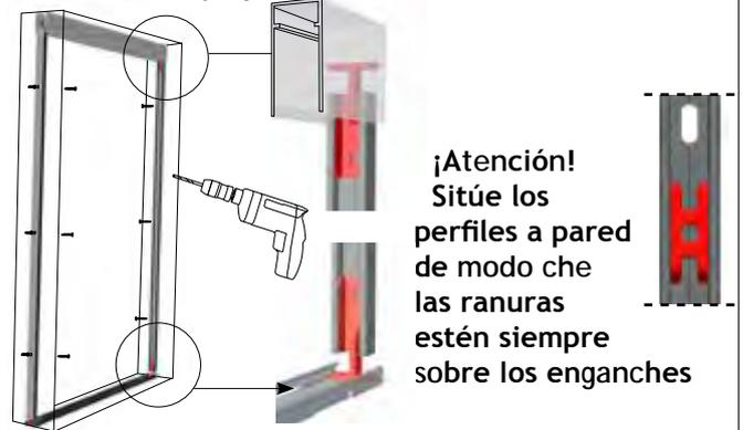
**C** Introducir el paquete mosquitera (5a+5b) entre ambas guías; desplazar el perfil imán (5a) contra el perfil a pared (3) ya fijado. Al contacto levantarlo ligeramente para consentir el enganche y recolocarlo.
