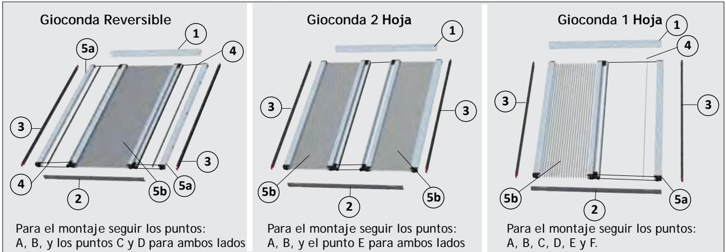
**A** Fijar en alto la guía superior (1), apoyar en el suelo el carril inferior (2) una vez despegada la protección biadhesivo
