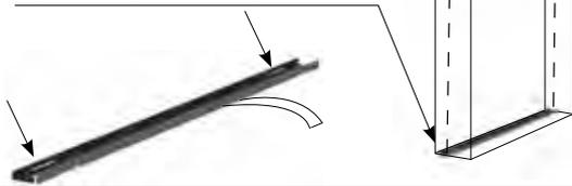
**B** Situar en el interior de las guías los perfiles a pared (3) y fijarlos sobre ambos lados del vano
